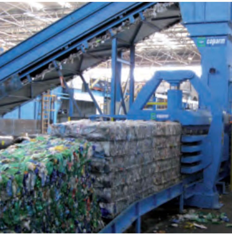
Пресс мод. PR 50 прессование ПЭТ - Baler mod. PR 50 PET packaging
