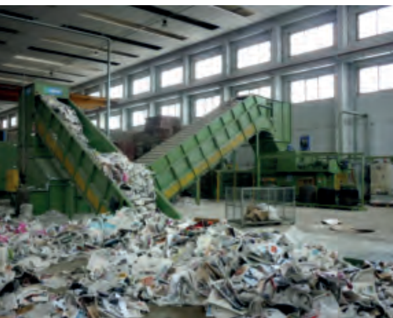
Оборудование для измельчения и прессования - Shredding and baling plant
