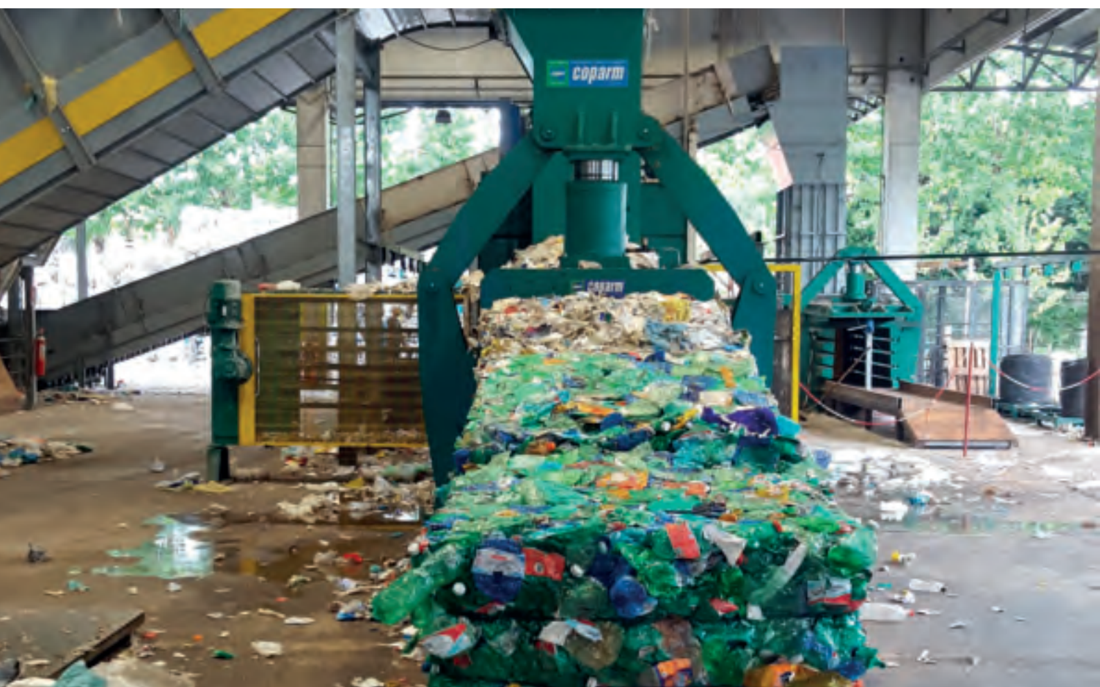
Пресс мод. PR 300 упаковка ПЭТ - Baler mod. PR 300 PET packaging
