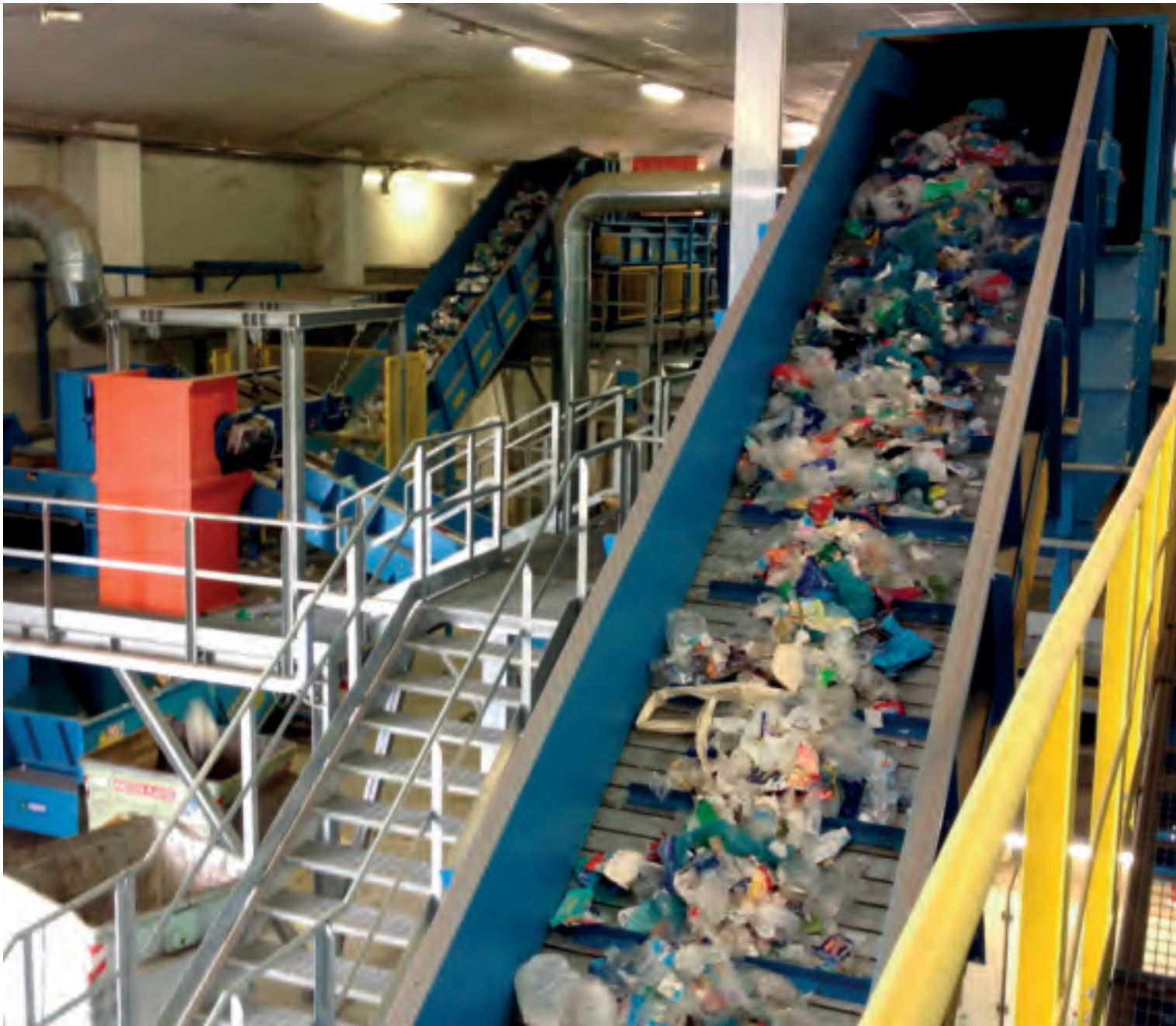
Линия сортировки смешанных ТБО 6 тонн/час - Multimaterial sorting line 6 ton/h
