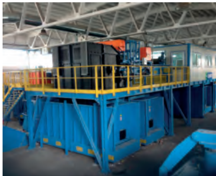
Оборудование для сортировки не разделенных отходов 5-6 тонн/час Multimaterial sep. collection sorting plant 5-6 ton/h
