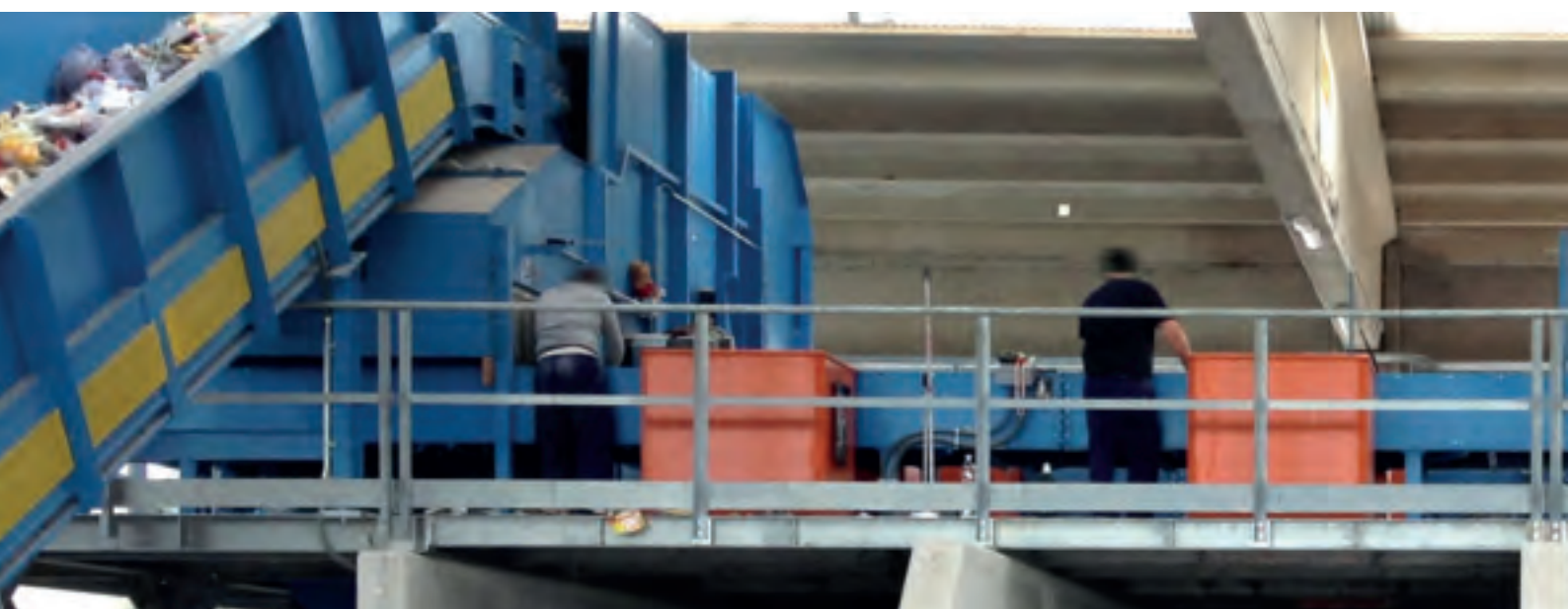
Оборудование для сортировки не разделенных отходов 5-6 тонн/час Multimaterial sep. collection sorting plant 5-6 ton/h
