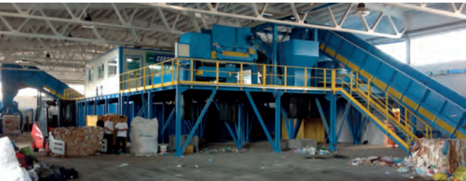
Линия сортировки бумаги + смешанной ТБО - Paper + multimaterial sorting plant
