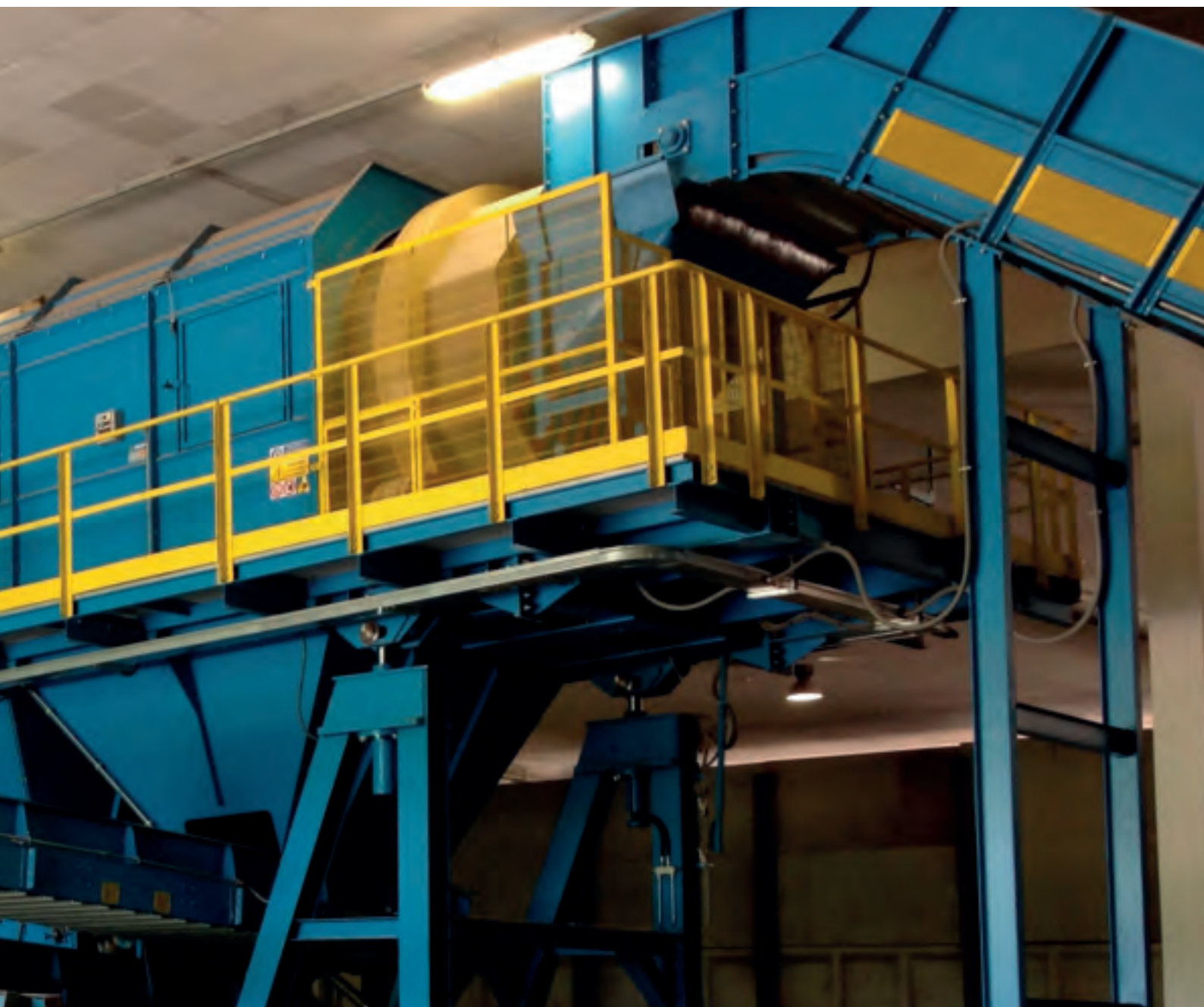
Баллистический барабан мод. VR8 2512 - Rotating screen mod. VR8 2512
