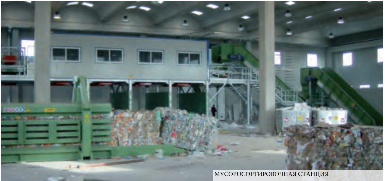
ПРЕСС РС 50 R ДЛЯ ПАКЕТИРОВАНИЯ ПЭТ-БУТЫЛОК
